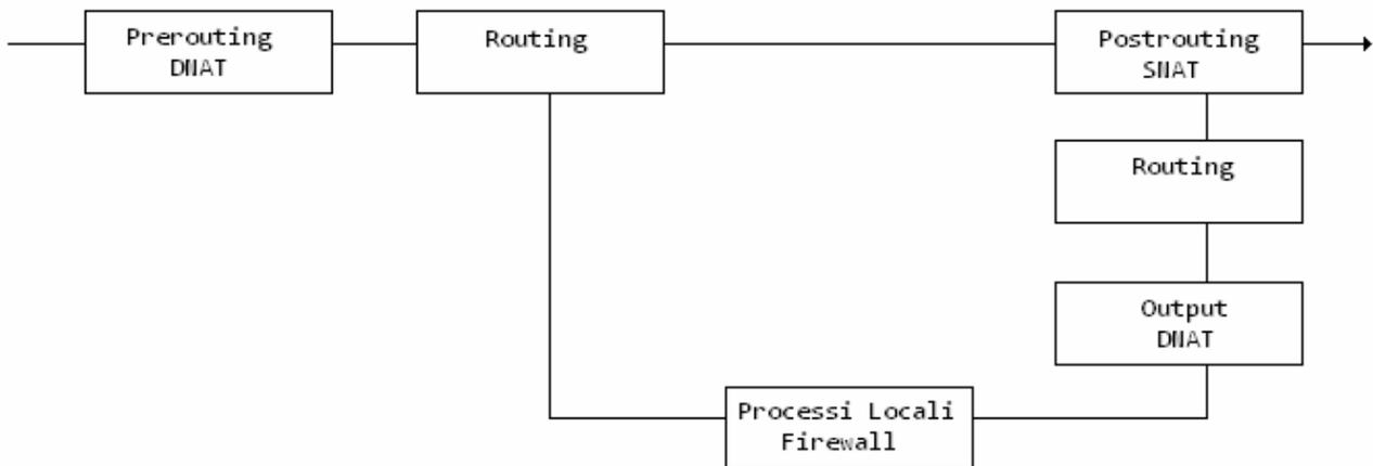
Nello schema soprastante è spiegato sinteticamente la funzione di routing suddivisa in prerouting, output e postrouting, i momenti nel quale devono essere eseguiti lo SNAT e il DNAT e quando interviene il lavoro del Firewall. Dnat è effettuato prima del routing e prima che i pacchetti siano filtrati invece Snat è eseguito dopo il filtraggio dei pacchetti. Anche su Windows è possibile modificare i pacchetti fino al livello MAC
